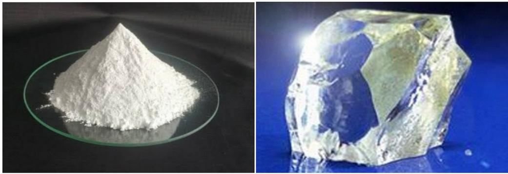
**Figure.II.2:**Formes cristallines d'oxyde de magnésium
