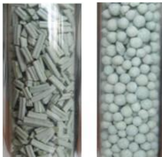
Figure. II. 6 : Exemple de chargement de catalyseur extrudé de type trilobes (à gauche) et billes (à droite) [12].
