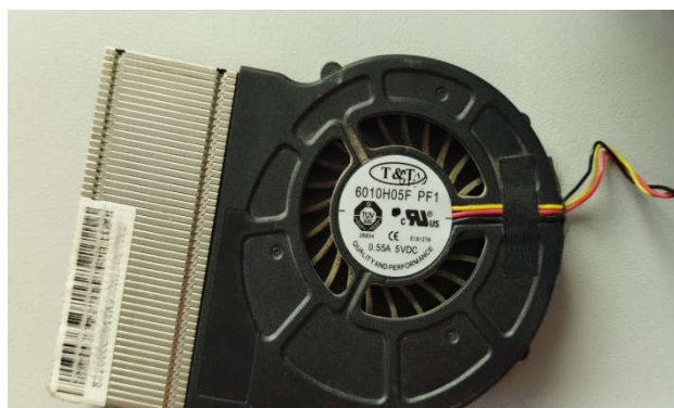
Fig 3.6 : Ventilateur (moteur 5V DC).
