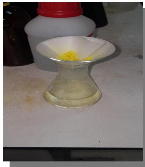
Figure III.3 : Préparation de la résine acide salicylique formaldéhyde (AF)
