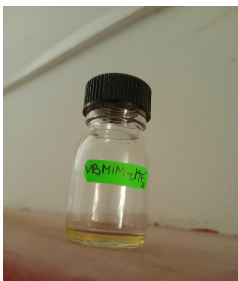
Figure III. 9: 1-méthyl-3-(4-vinylbenzyl) imidazol-3-ium bis (trifluorométhyl sulfonyl) imide ([VBmim-NTF 2 ]).
