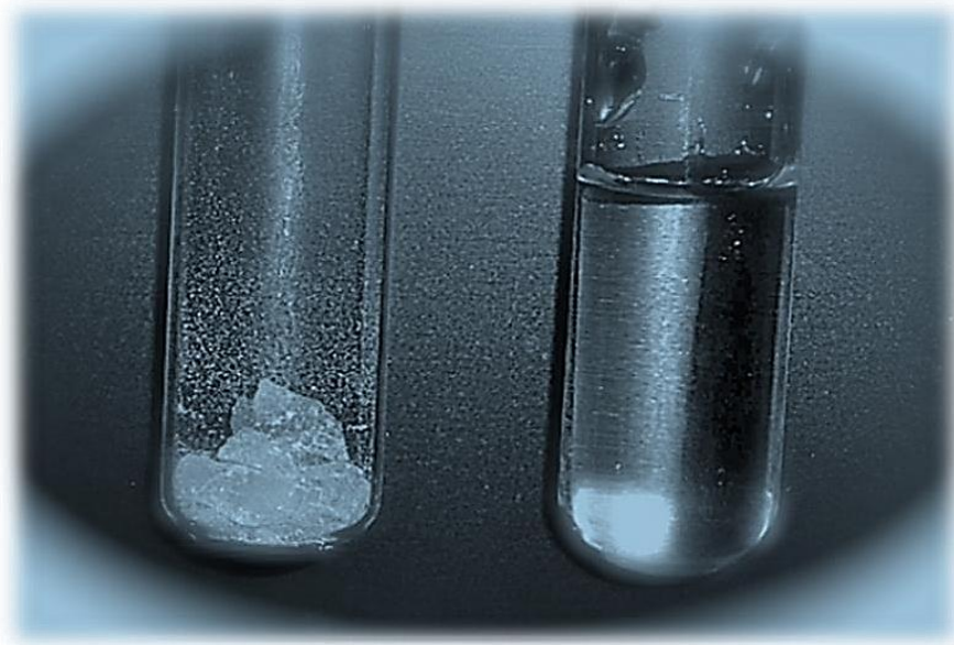
Figure I. 3: Le chlorure de sodium (à gauche solide à température ambiante et ne fond qu'à 800 °C), le LI à droite ([hmim][PF6]), est liquide à température ambiante [97]
