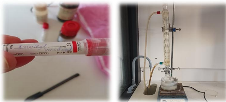
Figure.III.2. les produits utilisé avec montage de la synthèse ( [M(CH_2)IM_2+][2I] )
