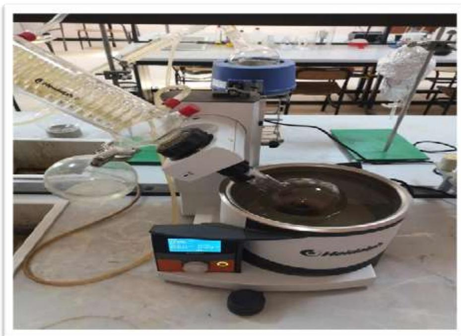
**Figure 7:** Evaporateur rotatif (originale).
