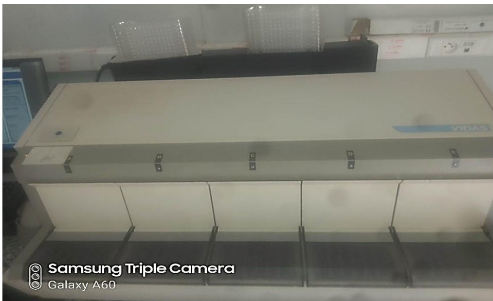
Figure 15 :Analyse automatique de plasma du sang dans la machine biomérique vidas photo original le (13\05\2023)
