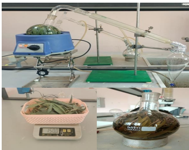
Figure n°13 : Diapositif de l'extraction d'HE par hydrodistillation (photo original 2023)
