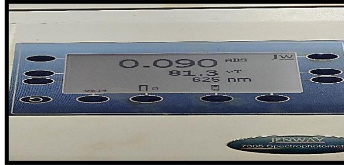
**Figure n°22 :** Lecture de la densité optique des suspensions bactériennes sur un spectrophotomètre (originale 2023)
