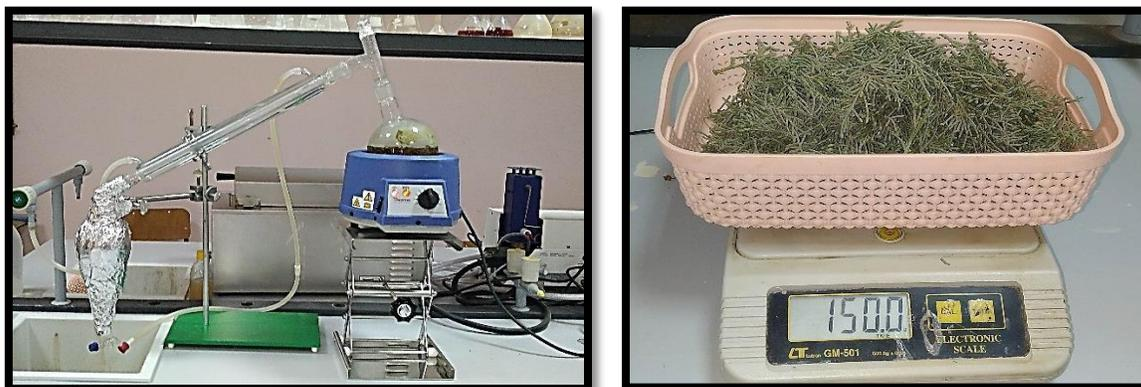
**Figure n°20** : Dispositif de l'extraction d'HE par hydrodistillation (Clevenger) (originale 2023)
