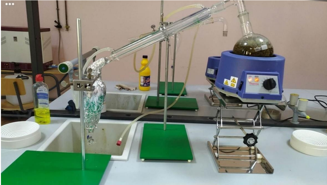
Figure 17 : Montage d'hydrodistillation type Clevenger (originale)
