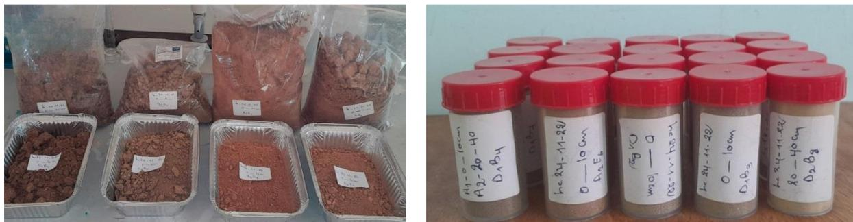
**Figure 4.5 :** séchage et broyage des échantillons de sol pour le dosage des ETM (le 12-12-2022).
