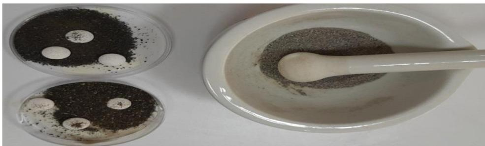
**Figure 4.6 :** Mélange échantillon-acide borique avant et après broyage (12-02-2023).
