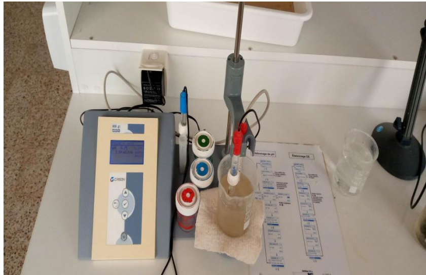
Figure 05 : multi paramètre : mesure lePH .T et a conductivité électrique. (Originale).
