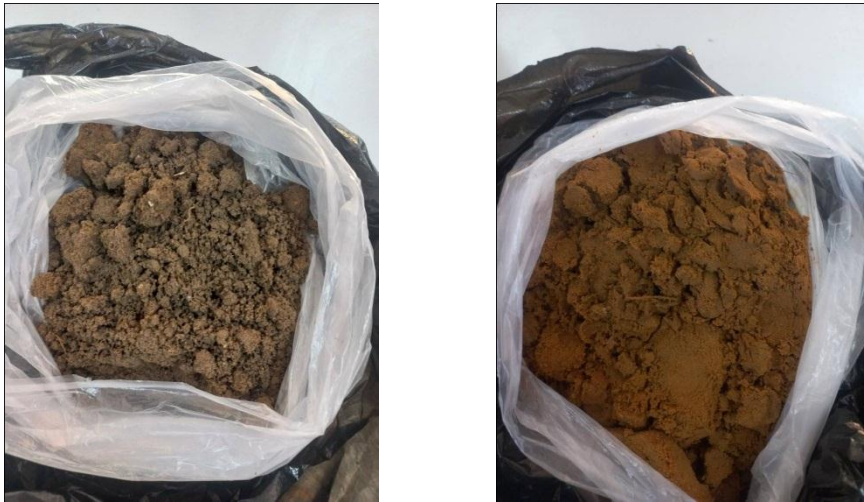
Figure 17: Les deux types de sol utilisés (sableux et limineux). (Original).
