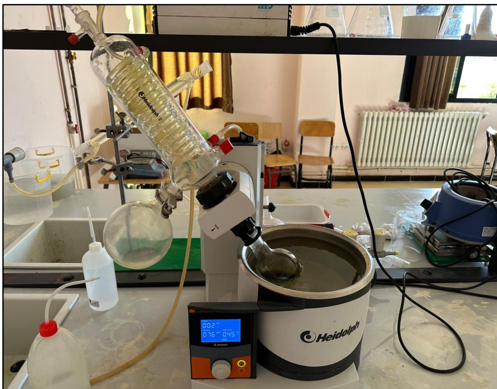
Figure 16 : Évaporateur rotatif pour récupération d'extrait hydro-ethanolique (Photo originale). 28/03/2023 16:29
