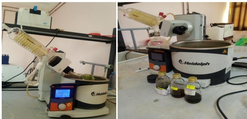
**Figure 13: évaporation des solutions d'extraction par Rota vapeur ( photo originale 2023 )**
