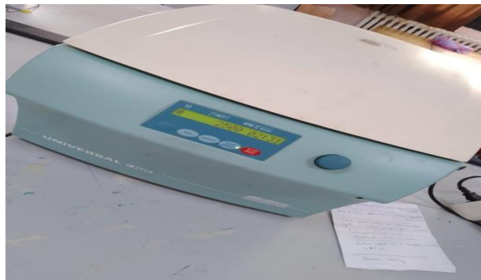
Figure N°20 : Centrifugeuse (photo original ,2023).
