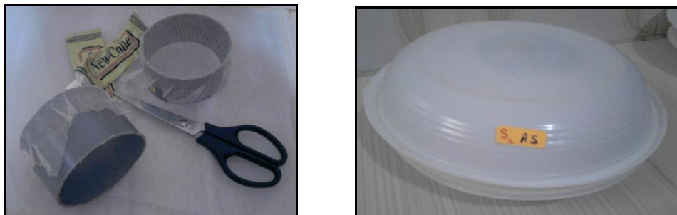
Figure 21 : Exemple d' un type de tamis et de soucoupes. Le modèle est constitué d'un tamis fait à main à partir de toile de moustiquaire attachée à une section de tuyau d'évacuation en PVC, Surélevé sur cales afin de faciliter la migration des nématodes dans l'eau. (Photos personnelles).
