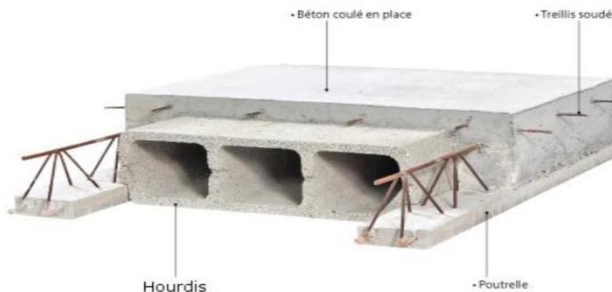
Figure II- 1 : Dalle à hourdis et poutrelles.
