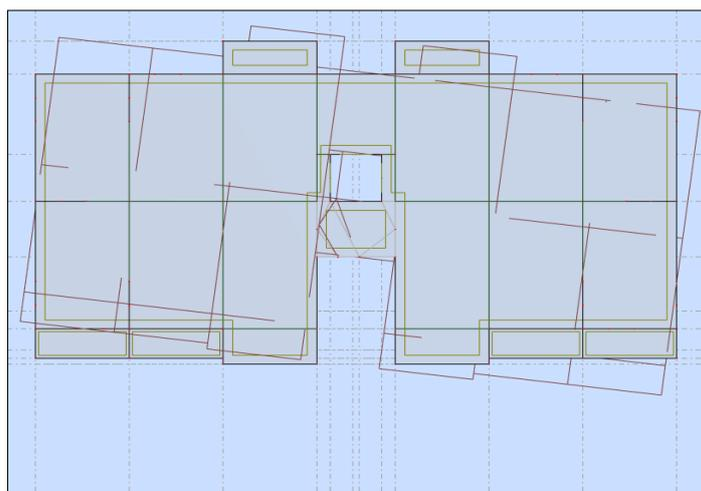
**Figure IV-5:**Le comportement de la structure après augmentation de la section des poteaux.
