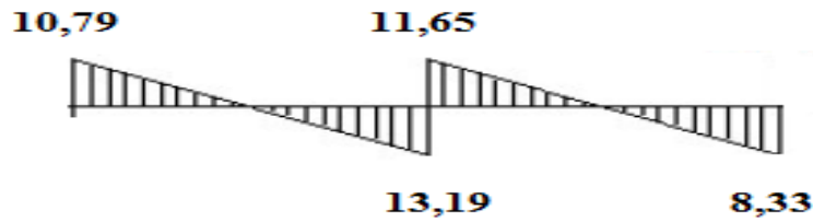
Fig II-35–Diagramme des efforts tranchants T [KN] à ELU
