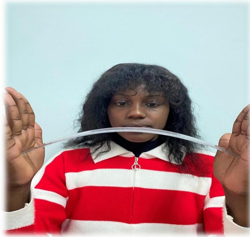
**Figure II.3** *Flambement associée à deux forces de compression.*
