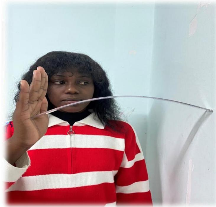
**Figure II.2** *Flambement avec charges de compression.*
