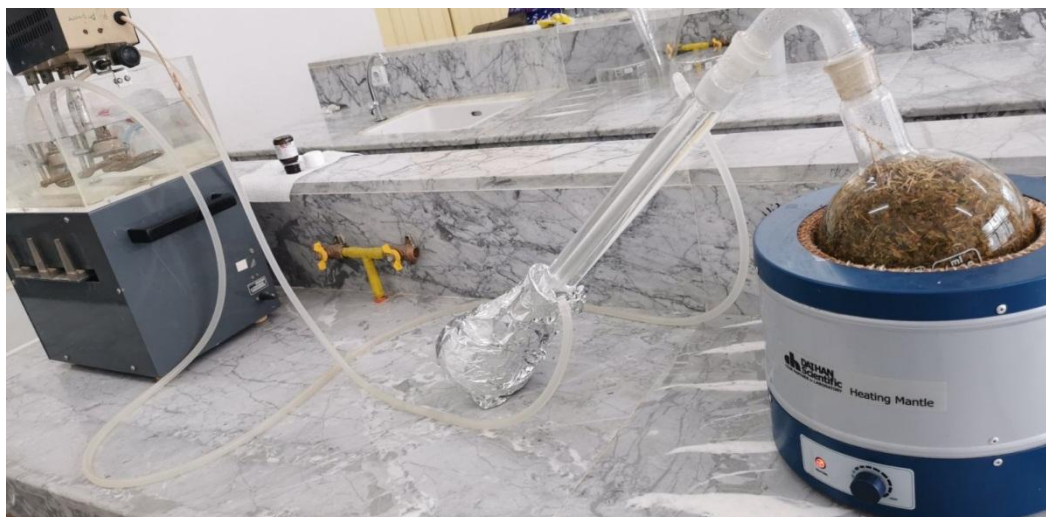
Figure19: Montage de distillation simple utilisé pour l'extraction des huiles essentielles (originale)
