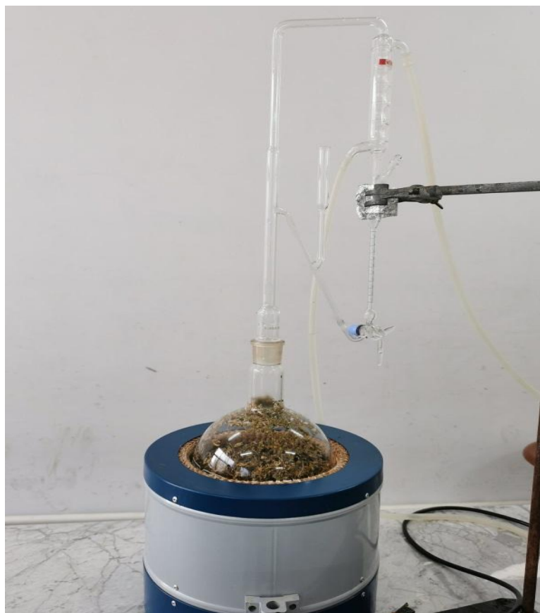
Figure 20 : Montage de type Clevenger utilisé pour l'extraction Des huiles essentielles ( originale ) .
