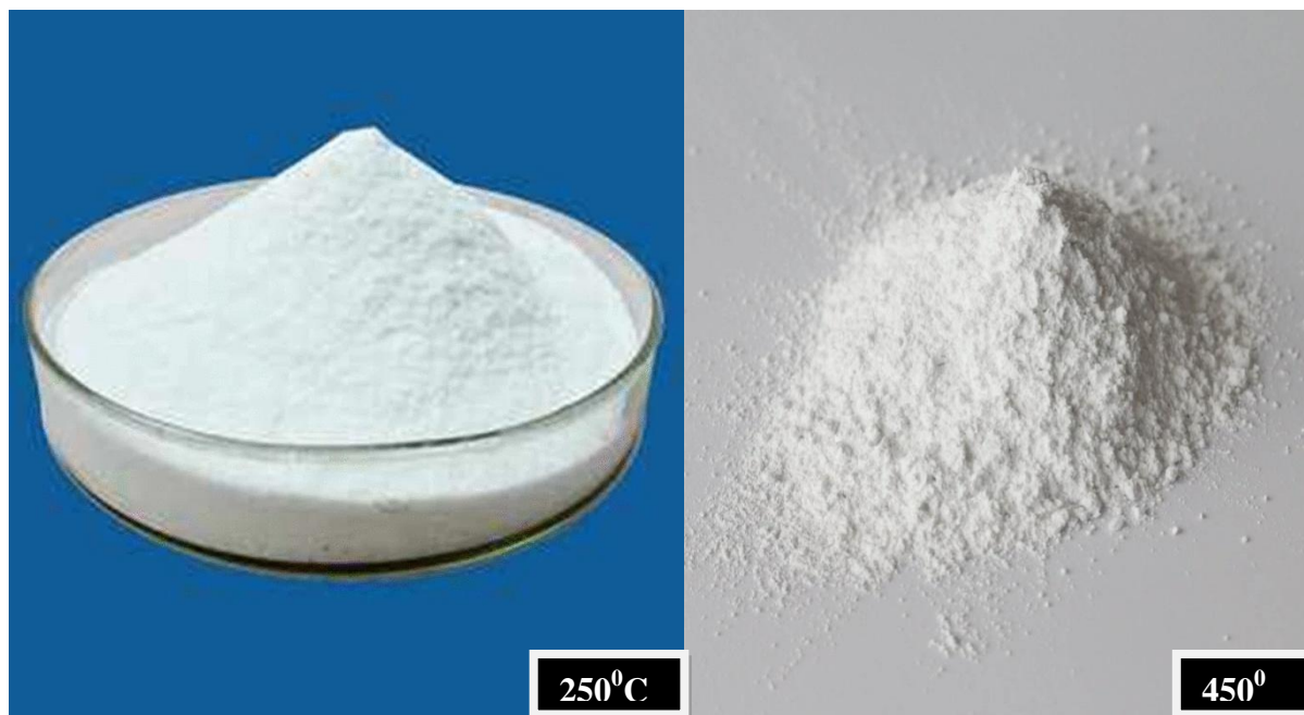
Figure I.18 : photographies des poudres d'un matériau Al-CMI-1 calciné à différentes température.
