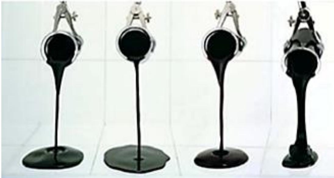
**Figure 1.4.**Types de bitume pur
