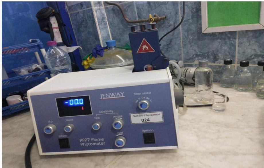
**Figure 12** Photomètre de flamme JENWAY PFP7
