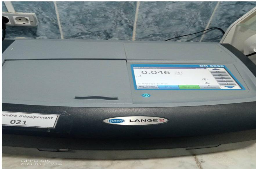
**Figure 11 Spectrophotomètre HACH DR6000**
