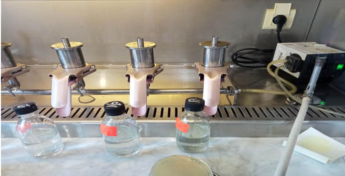
Figure 13 Rampe de filtration
