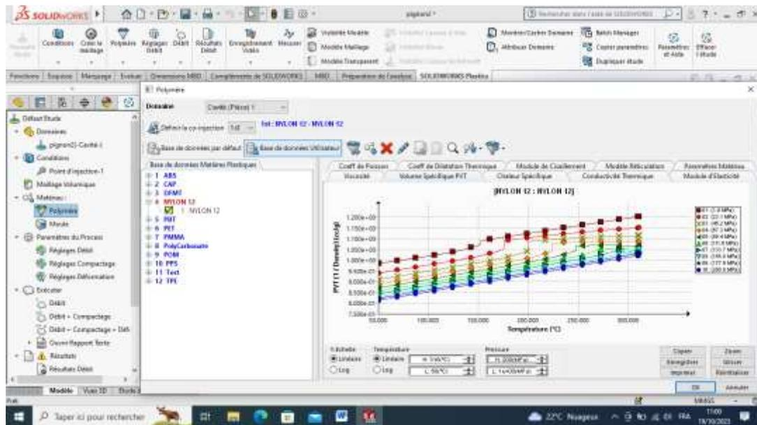
Figure III.10: Volume spécifique du Nylon en fonction de la température.
