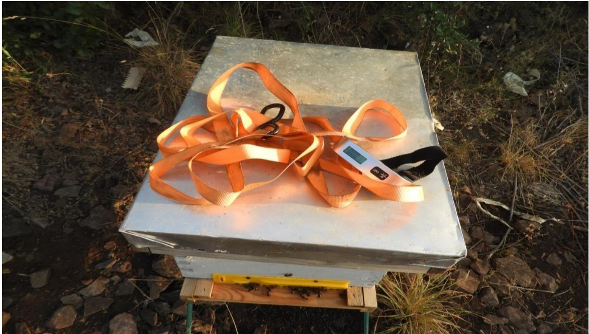
Figure 2.6 : Matériels utilisée pour la pesée des ruches.
