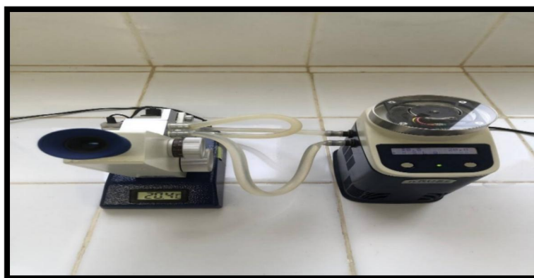
Figure 4 : Réfractomètre utilisé pour la mesure de l'indice de Brix
