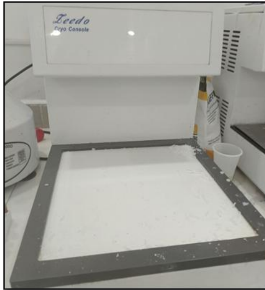
Figure 29: Station d'inclusion en paraffine (Zeedo) utilisée pour la confection des blocs.
