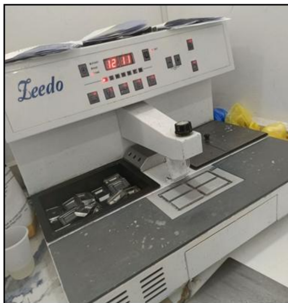
Figure 28: Plaque réfrigérante (Cryo Console Zeedo) utilisée pour la solidification rapide
