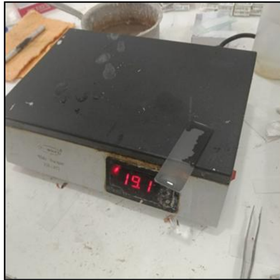
Figure 31: Séchage des lames histologiques sur un plateau chauffant (Slide Warmer) avant la coloration.
