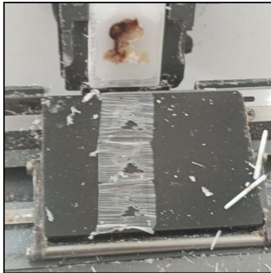
Figure 30: Réalisation de coupes fines de tissus inclus en paraffine à l'aide d'un microtome.
