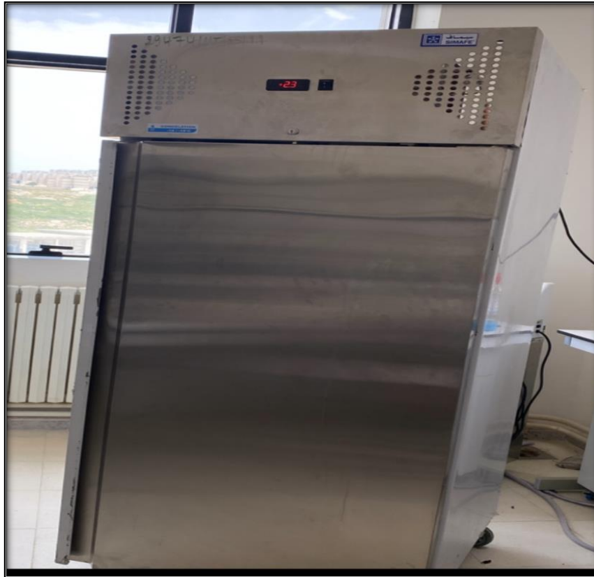
Figure 8 : Armoire de congélation basse température utilisée pour la conservation des échantillons.
