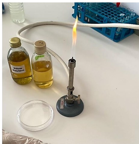
Figure N°20 : zone stérile à l'aide d'un bec Bunsen (original)
