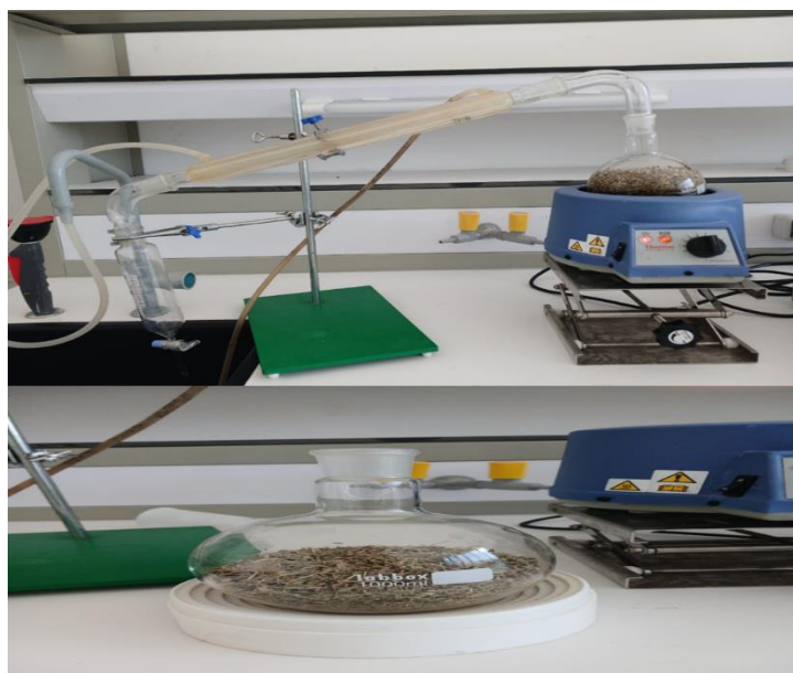
Figure n°14: Dispositif d'extraction des huiles essentielles de Thymus vulgaris .
