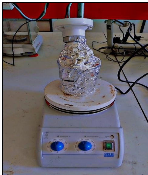
Figure II.10 : Montage expérimental de photocatalyse sous irradiation UV .
