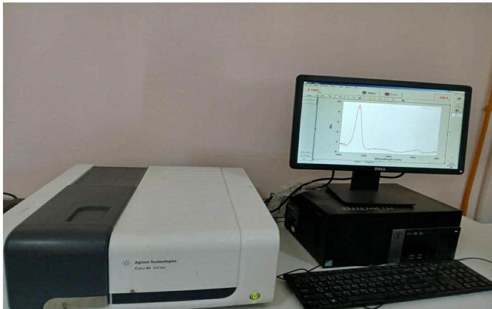
Figure 9 Mesure de la longueur d'onde maximale \lambda_{\text{max}} spectrophotométrie UV-Vis
