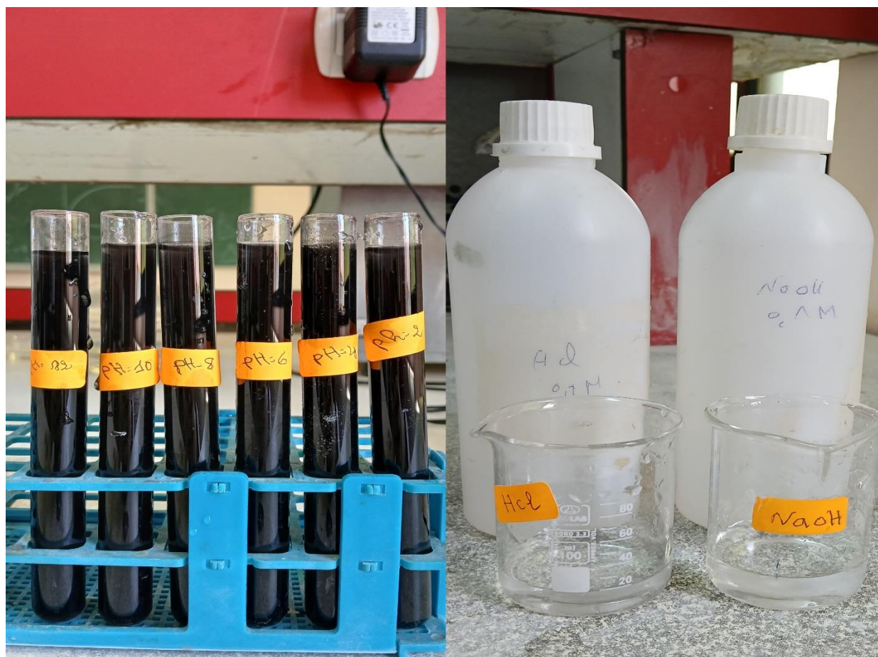
Figure 12 Préparation des solutions à différents pH (2–12) à l'aide de HCl et NaOH pour l'étude de l'élimination du Chlorazol Black.
