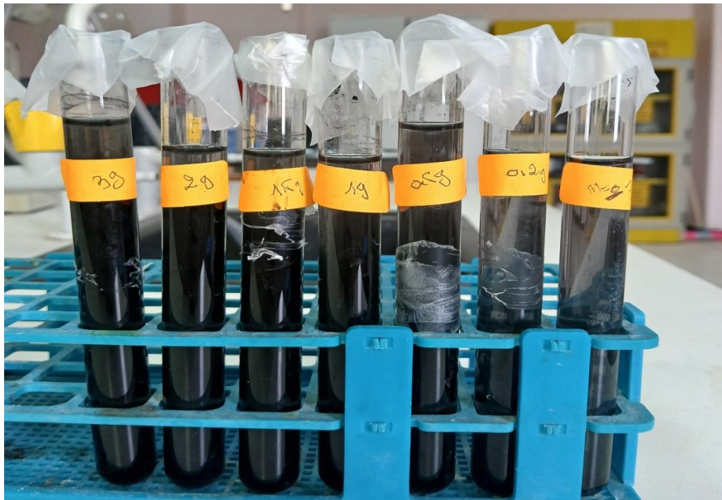
Figure 11 Préparation des tubes avec différentes masses de charbon actif
