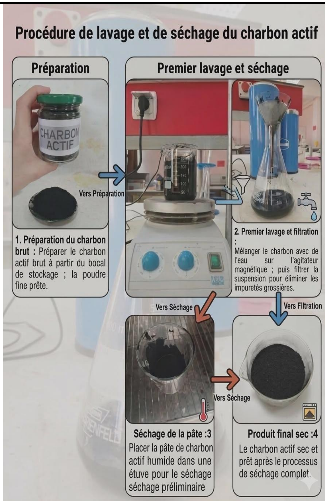
Figure 10 Protocole de préparation du charbon actif au laboratoire universitaire.
