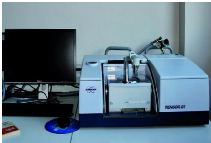
FigureII–18 :Spectromètre infrarouge utilisé pour les analyses [7].
