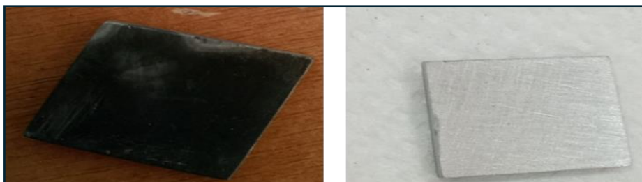
Figure II.6 : Les pièces en acier au carbone XC38 avant et après le polissage.
