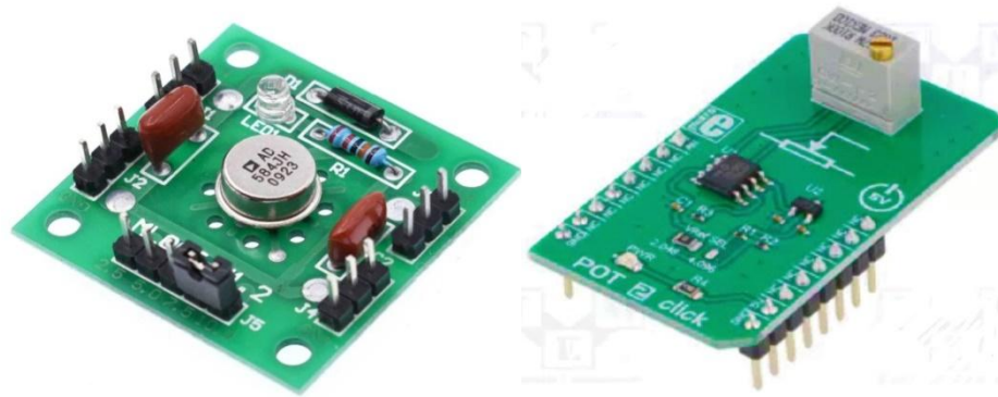
Figure III.1 : Modules de référence de tension utilisés pour l'étalonnage : AD584 et MCP1541
