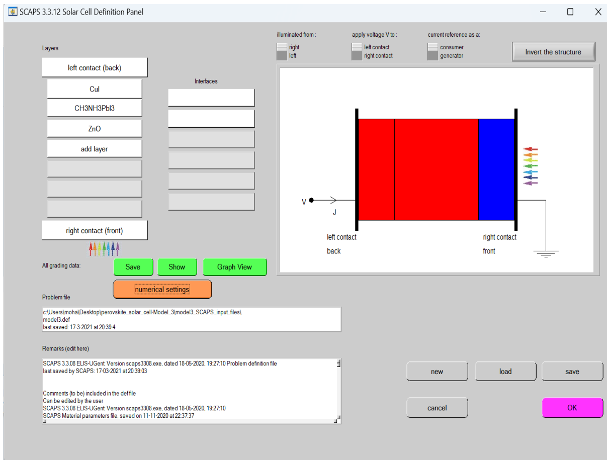
Figure III.8 : Définition de la structure d'une cellule solaire.
