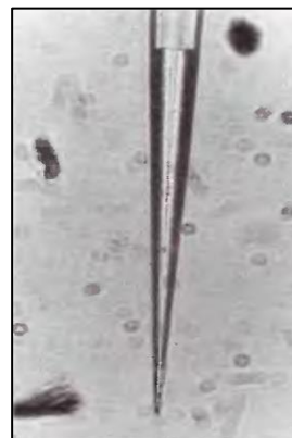
Figure 21. Microélectrode liquide à potassium contenant 125µm d'échangeur d'ion dans sa pointe (x400)
