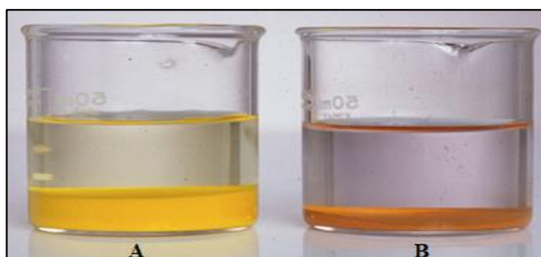
Figure 07. Deux précipités de \text{PbCrO}_4 , obtenus par a) précipitation homogène et b) précipitation directe
