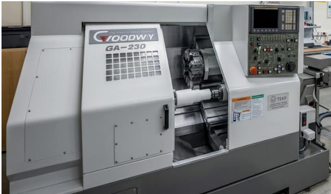
Figure 2.1- Tour à commande numérique (CNC, marque GOODWAY GA-230).
