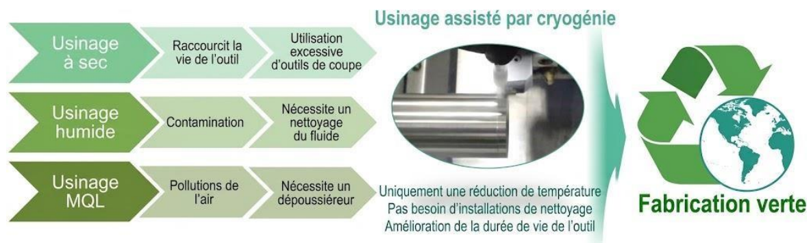
Figure 1.3- Avantages de l'usinage assisté par cryogénie pour une fabrication durable [3].
